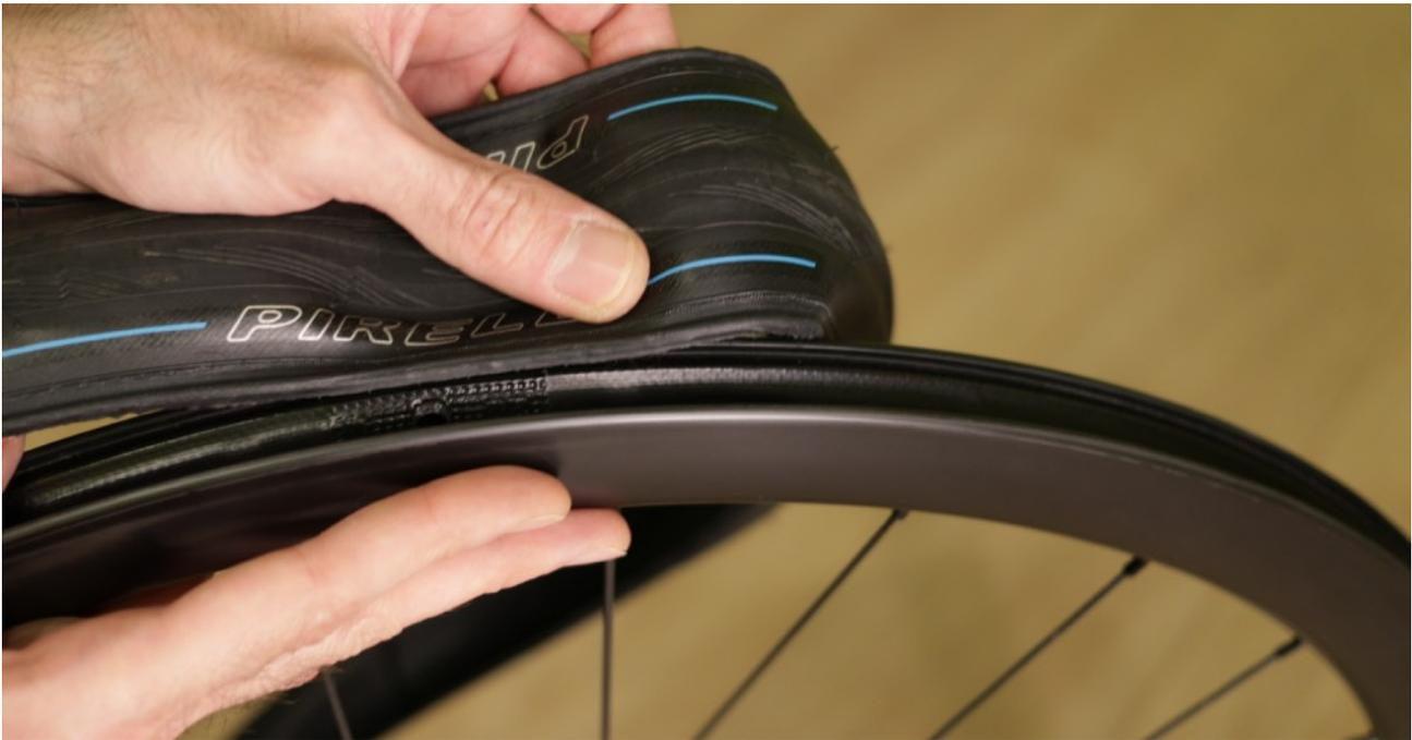
**09.** Prendete lo pneumatico, controllate il senso di rotazione in cui dovete montarlo, individuate la scritta, di solito è la marca, e ponetela al centro in corrispondenza con il foro per la valvola presente nel cerchio.
