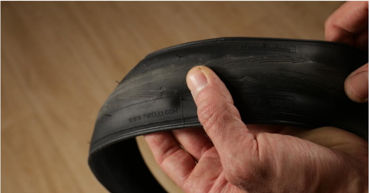
**05.** Quanto avete smontato completamente lo pneumatico dal cerchio, è buona norma controllare in maniera accurata sia il battistrada che la parte interna, assicuratevi che non vi siano detriti incastrati nella mescola o che abbiano attraversato lo spessore del pneumatico, potrebbero causare un'inevitabile foratura subito dopo il montaggio, o ancor peggio nella fase di ultimo gonfiaggio.
