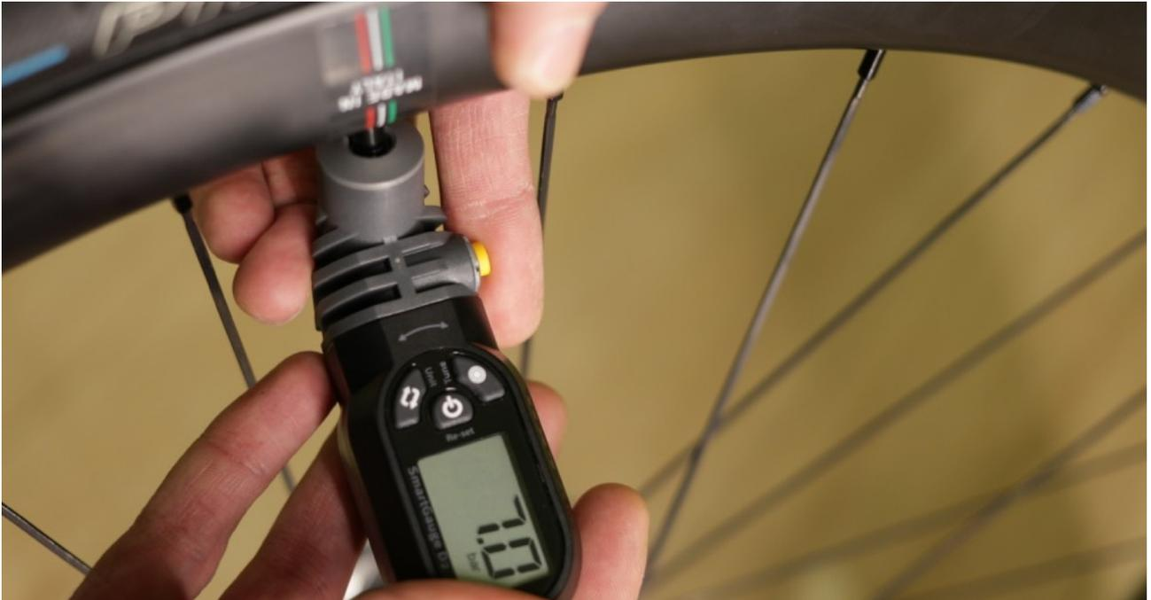
**16.** La fase finale a completamento della procedura è ripristinare la propria pressione ideale di gonfiaggio del pneumatico.
