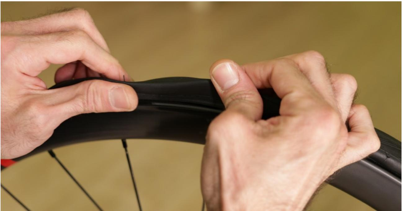
Consigliamo l'uso delle mani per non danneggiare specialmente ruote in carbonio, con pneumatici di alta gamma questa operazione risulta abbastanza facile.
