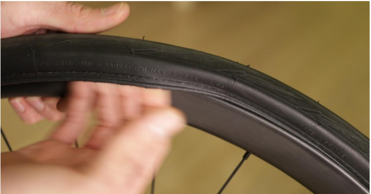
**03.** Una volta che parte del pneumatico è fuoriuscita, fate scorrere all'interno tra pneumatico e cerchio le dita o eventualmente un cacciagomme per completare l'operazione di smontaggio del pneumatico.
